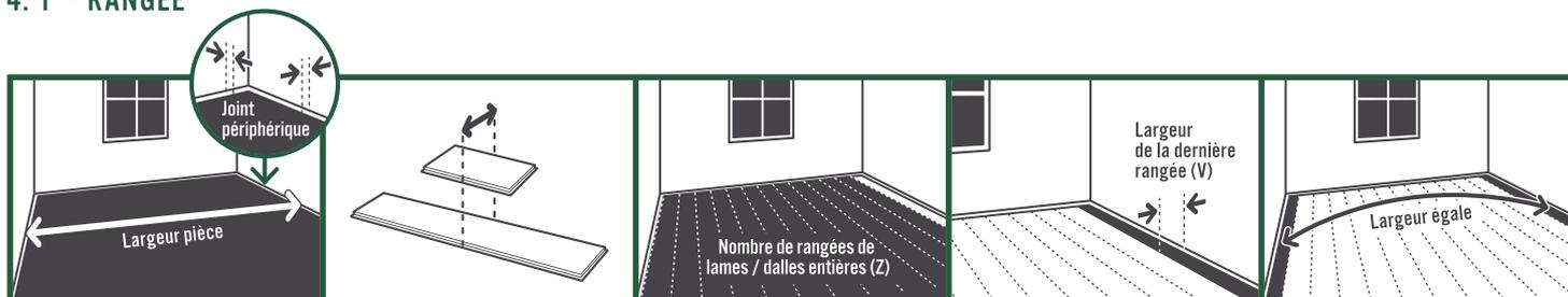
$X = \text{Largeur pièce} - (\text{joint} \times 2)$
