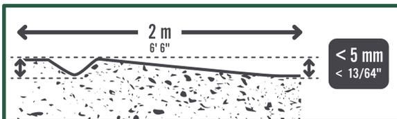
La planéité doit être  $< 5 \text{ mm}$  sous la règle de 2 mètres.
