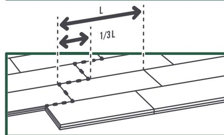
Démarrage de la pose dans un angle de la pièce.
