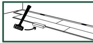
Terminer l'assemblage à l'aide d'une cale à frapper.
