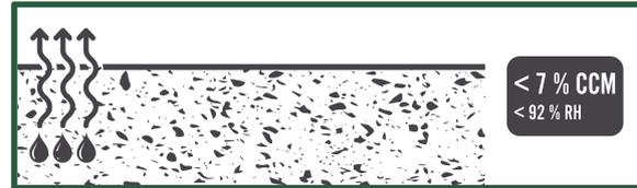
Le taux d'humidité ne doit pas excéder 7 % au test de la bombe à carbure (Control Carbide Moisture) et ne doit pas avoir de risque de remontées d'humidité
